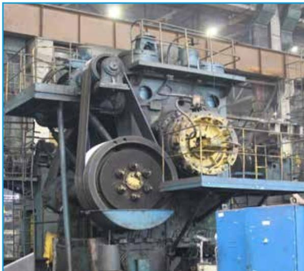
**Пресс обрезной, на котором отсутствует защитное ограждение привода**
