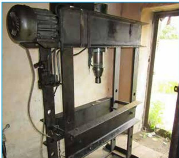
**Гидравлический пресс ОКС-1671, эксплуатируемый без предусмотренного заводом-изготовителем манометра для контроля за давлением рабочей жидкости в системе**
