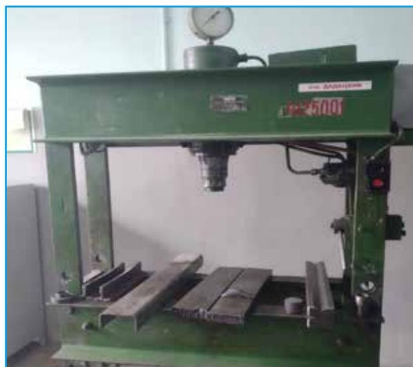
**На подключенном к электрической сети гидравлическом прессе, контрольно-измерительный прибор (манометр) имеет истекший срок поверки. Данный пресс оборудован одноручной системой управления. При этом в нем отсутствовало защитное устройство рабочей (опасной) зоны**
