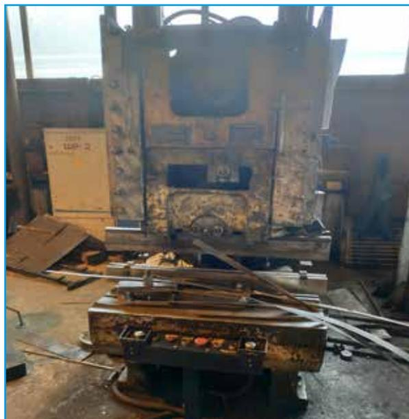
**Пресс KE 2130, эксплуатируемый с технической неисправностью пневматического распределителя, не прошедшего планово-предупредительный осмотр и ремонт**
