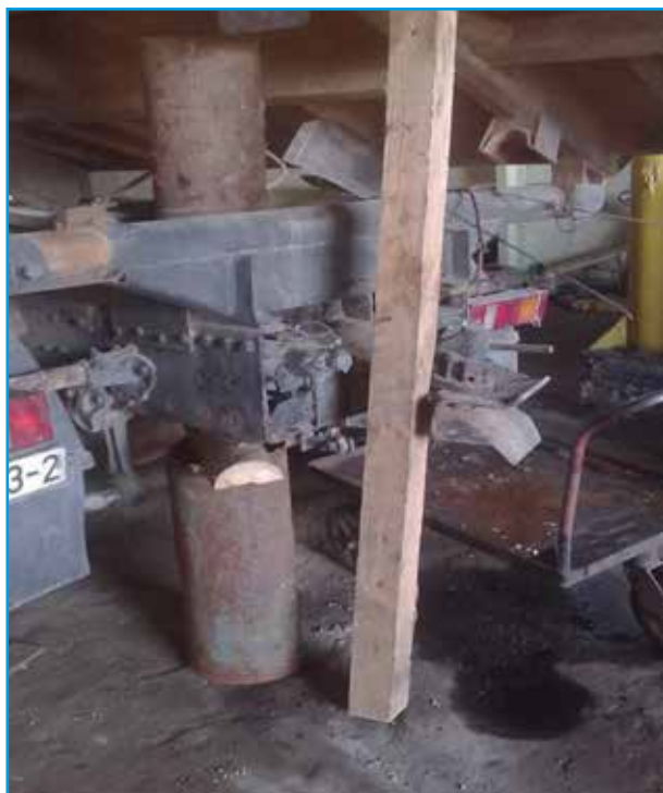
При ремонте автомобиля МАЗ вместо специальных упоров под поднятый кузов применяются случайные предметы (деревянный брусок и деревянная колодка)
