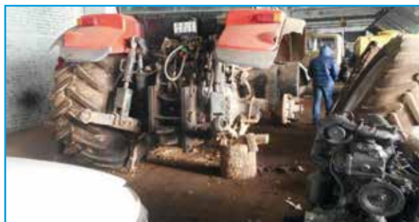
Находящийся на ремонте трактор установлен на случайные предметы (деревянные колодки и доски), беспорядочное складирование запасных частей, деталей
